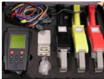
Analizador de redes eléctricas coas correspondentes pinzas
