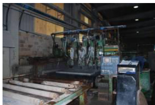
Máquina de corte de pranchas
