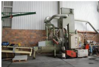
Máquina de granallado
