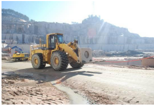
Pa cargadora para o transporte de bloques ao punto de almacenamento
