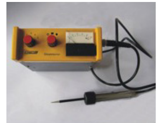
Detector de fugas por ultrasóns
