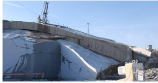
Extracción de bancada con máquina de corte con fío diamantado. Na parte superior obsérvase un banqueador pneumático perforando o macizo
