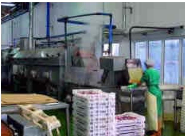
Sobre estas liñas, un cocedoiro continuo para luras e chocos. Á dereita, balsas para o cocido en descontinuo de diversos tipos de peixe.
