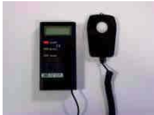
Luxómetro para a medición do nivel de iluminación para a medida de tensións e intensidades
