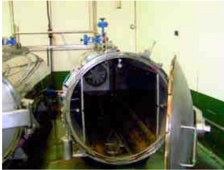
Cocedoiros de vapor válidos para a esterilización e a cocción.
