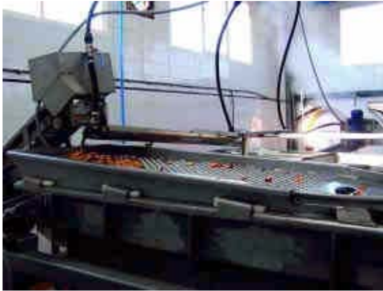
Criba vibratoria para a clasificación por tamaño do mexillón
