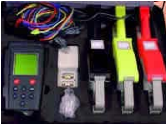
Analizador de redes eléctricas coas correspondentes pinzas
